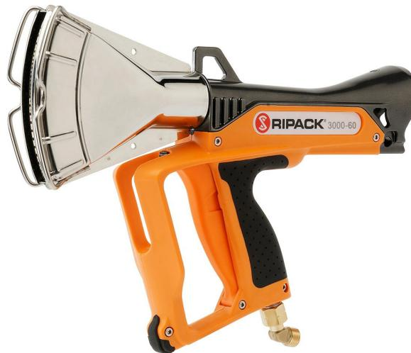
Die Ripack 3000 Handschrumpfpistole ist ein zuverlässiges Profiwerkzeug für das sichere und effiziente Schrumpfen von Folienverpackungen im Lager-, Versand- und Palettenbereich. Mit einer Leistung von 45–76 kW (153.000–260.000 BTU) und einem Arbeitsdruck von 1,5–3,5 bar (21–50 PSI) eignet sich das Gerät für den intensiven Dauereinsatz. Die Pistole ist gasbetrieben (Propangas) und erzeugt eine Lautstärke von unter 85 dBA.
